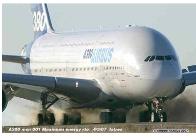
A380 msn 001 Maximum énergie rto 4/3/07 Istres
